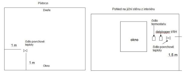
Čidlo povrchové teploty – surface temperature sensor
